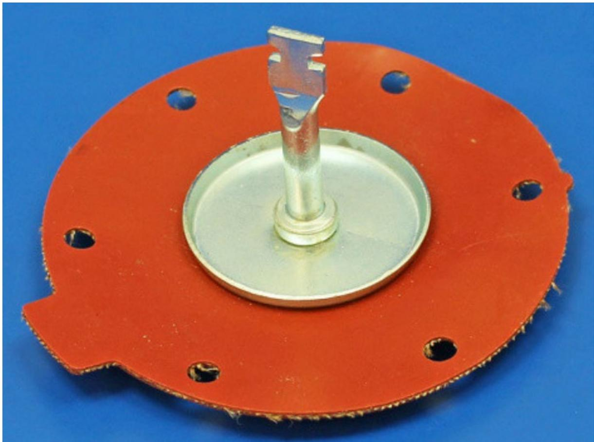
Die Membran muss für den Ausbau nach unten gedrückt (komprimiert) und um 90° gedreht werden. Der Einbau ist ein bisschen "kniffliger" und erfordert ein bisschen Geduld.
