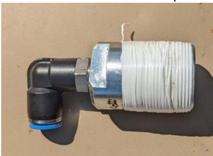
Bild: Buzzetti Polradabzieher M28x1.25, umgebaut auf 1/4" Schlauchanschluss
