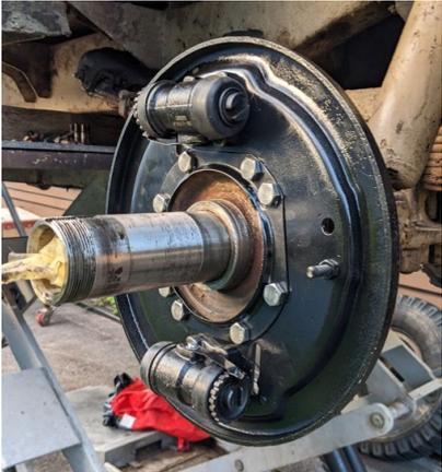
8. Radbremszylinder demontieren
