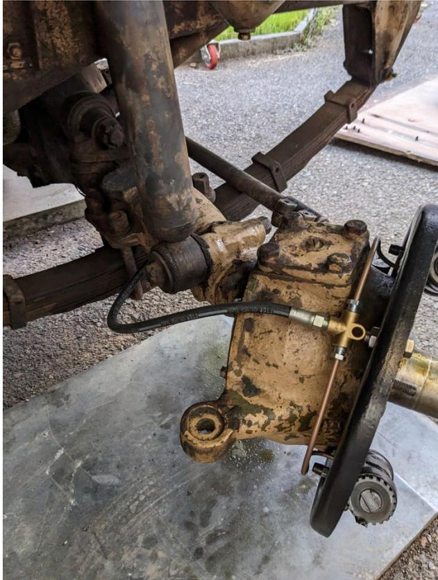
Bremsleitungen Vorderachse links / rechts (Befestigungswinkel nicht auf dem Foto)
