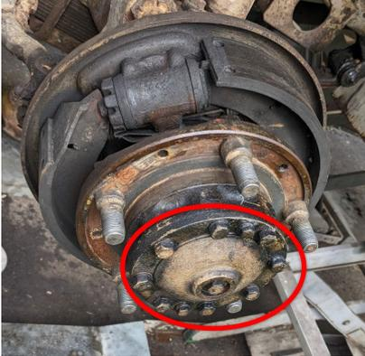
4. Radnaben demontieren
