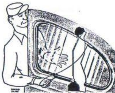
Bild 205. Fastsättning av ruta.
