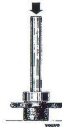
Bild 28. Montering av fläktnav.
