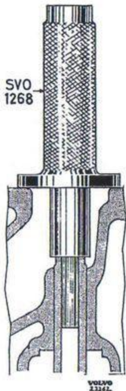
Bild 42. Montering av ventilstyrning.
