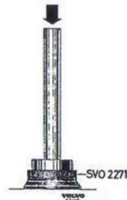
Bild 27. Montering av axel i lager.
