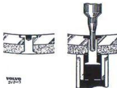
Bild 127. Demontering av nit.
